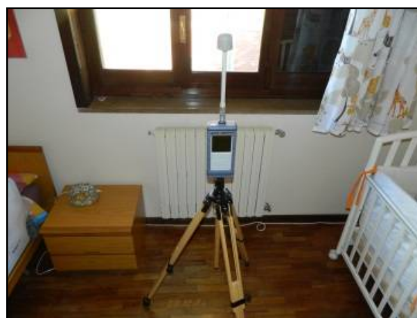
Fig. 1 - Tipico strumento di misura con sensore RMS
