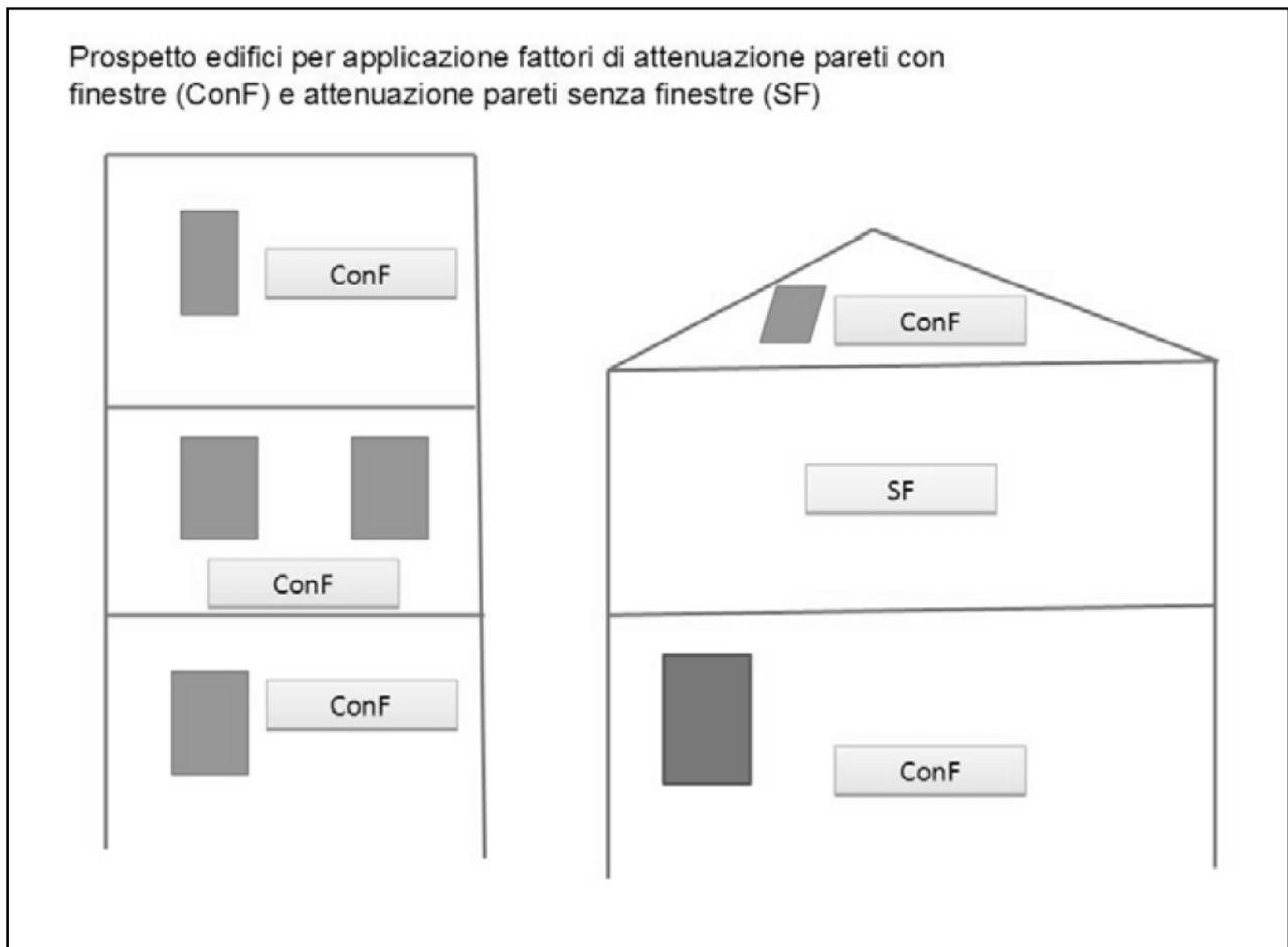
L'attenuazione 0 dB (se non indicato diversamente dal gestore secondo quanto stabilito in precedenza) per PARETE CON FINESTRA e' da considerare nel calcolo del campo elettromagnetico in quelle aree che sono direttamente in linea di vista con l'antenna ovvero per le quali la retta congiungente l'antenna ed un punto posto all'interno dell'edificio non intercetta altro ostacolo se non la suddetta parete con finestre o altre aperture.
